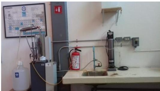
Planta piloto destilación de agua desionizada
