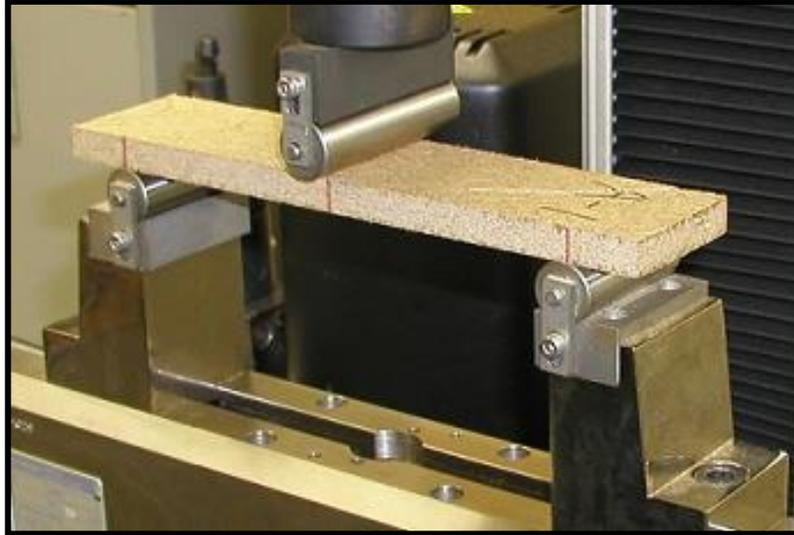
Figura 9. Ensayo de flexión estática.
