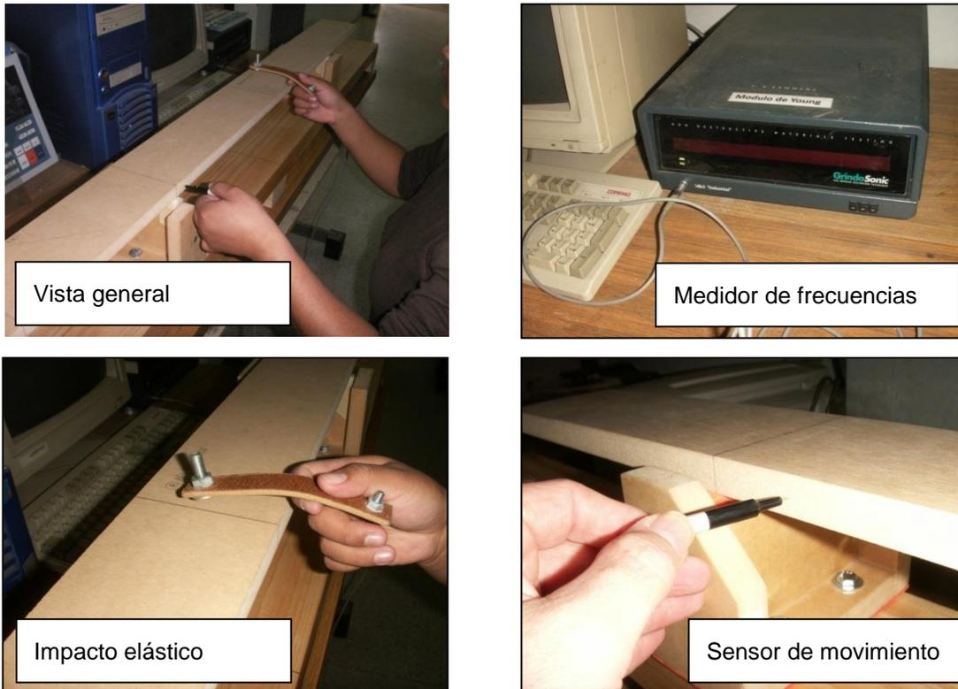
Figura 6. Detalles de las pruebas de vibraciones transversales.
